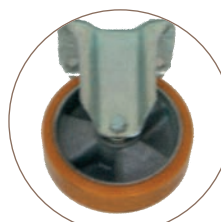
Rueda con banda de poliuretano Ø 125 y 150 mm Llanta de aluminio y buje de bolas
